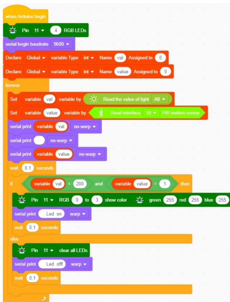
24. ábra: Feltételes vezérlés blokk-szerkezete analóg bemenethez (Forrás: https://docs.keyestudio.com )
