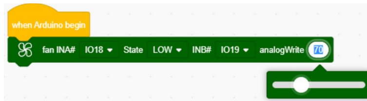
35. ábra: Ventilátorvezérlés blokk-logikai diagramja (Forrás: https://docs.keystudio.com )
