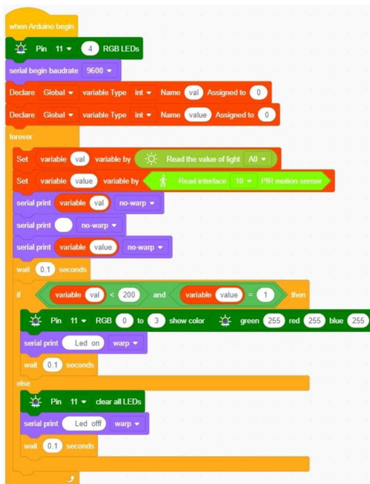
Figura 24: Structura blocului de control condiționat pentru intrarea analogică (Sursa: https://docs.keyestudio.com )
