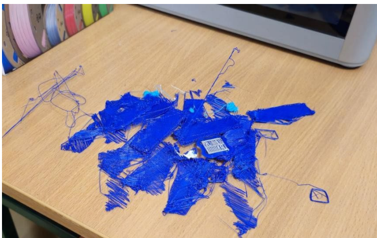
Figura 61: Rezultatele imprimării incorecte (Sursa: Editare proprie)
