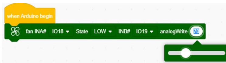
Figura 35: Diagrama blocului logic de control al ventilatorului (Sursa: https://docs.keystudio.com )
